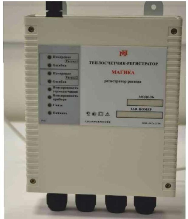
Регистратор расхода «Магика-РИ1000» обслуживает один трубопровод, а «Магика-РИ2000» одновременно может обслуживать два трубопровода. При этом метрологические характеристики его каналов калибруются автоматически на проливном стенде с расхождением между каналами не более 1%.
