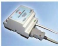
Адаптер GT232-485 является преобразователем собственного протокола RS232 в протокол RS485. Шлюз предназначен для увеличения длины линии связи между теплосчетчиком и диспетчерским пунктом, а также объединения нескольких теплосчетчиков «Магика» в локальную единую сеть. Сеть организуется путём их параллельного подключения к линии связи RS485. Общая протяжённость сети может достигать 1000 м. Количество абонентов - до 32 шт. Для соединения шлюзов используется кабель типа «витая пара» в оплетке.
