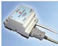
Адаптер интерфейса GT232-Ethernet является преобразователем собственного протокола RS232 в протокол TCP/IP. Адаптер предназначен для объединения теплосчетчиков «Магика» в единую локальную сеть, поддерживающуюся провайдером, либо глобальную сеть Internet.
